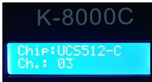
8. 写完地址码以后，先按住“芯片 CHIP”的，再同时按“模式 MODE”按键切换到播放模式，将芯片切换到 Chip: 10 此时即为 DMX512 标准协议 250K 播放模式，此时按模式键和速度键即可分别切换播放模式和调节速度，如下图
