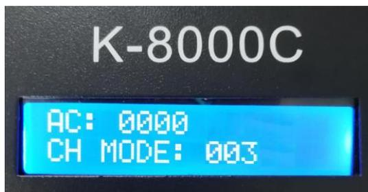
3. 按“模式”键开始测试（数字开始计数）；按“芯片”键切换手动通道测试模式和自动通道测试模式；
