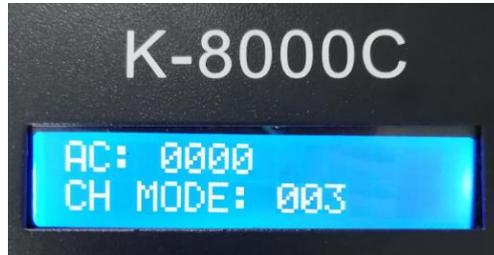
5. 按“模式 MODE”键进入“AC”自动测试模式，灯具开始依次跑马亮灯；控制器显示如下图（间隔通道为写码时设定不可调整）
