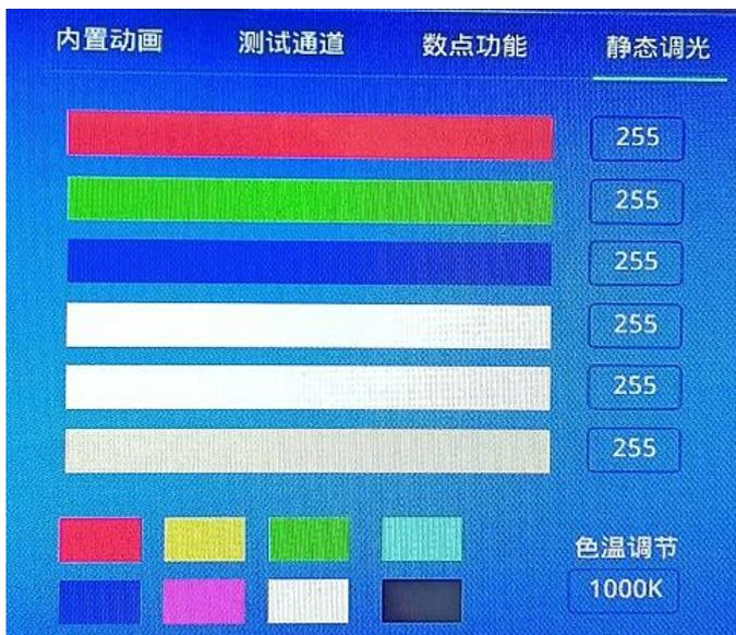
各通道亮度: 0-255 之间临时性修改颜色 (可点击颜色条修改; 也可点击数字, 弹出数字键盘输入数值修改)。
